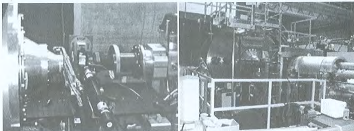
Kombination von dynamischer Lichtstreuung und Kleinwinkel-Neutronenstreuung, aufgebaut am SANS Instrument der schweizerischen Spallationsquelle SINQ am PSI
